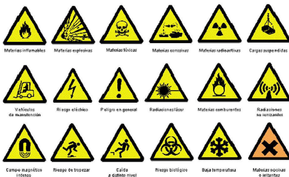
Figura 1. Señales de advertencia.
