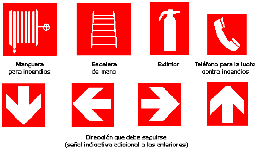
Figura 4. Señales de equipos contra incendios.
