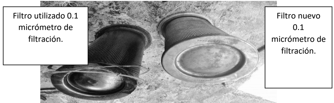
Figura 34. Filtro separador de aire del aceite de compresor Ingersoll Rand
