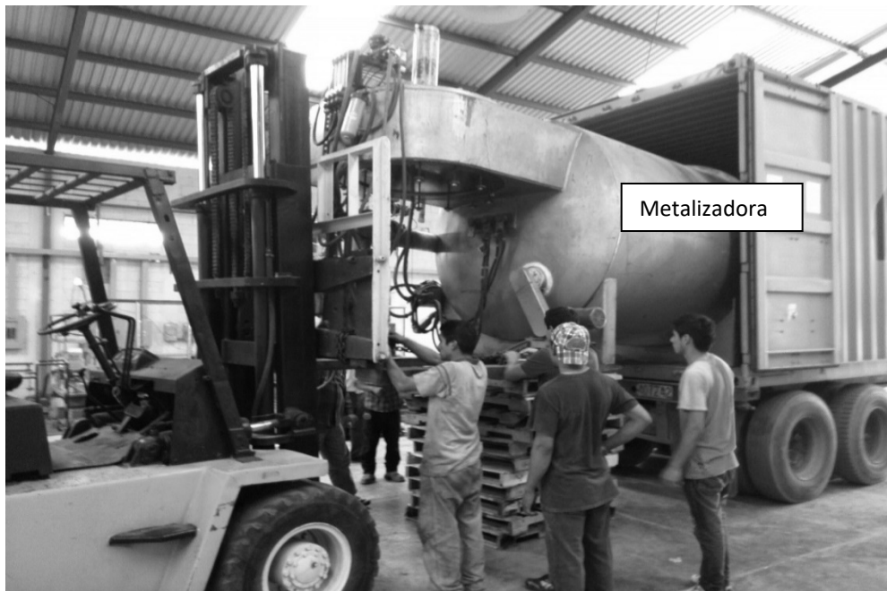
Figura 24. Manipulación de equipos con cuerdas y tarimas. La máquina se coloca en una base de tarimas para sujetarla con lazos para que el contenedor salga
