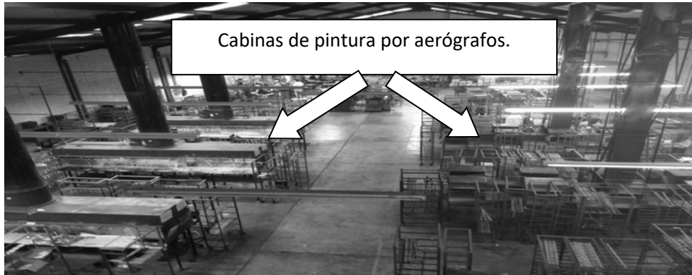
Figura 64. Área de pintura por aerógrafo. Bodega B
