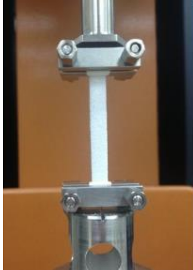
Figura 54. Ejecución de ensayo de tensión
