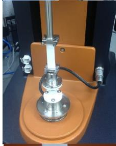
Figura 59. Ejecución de ensayo de torsión
