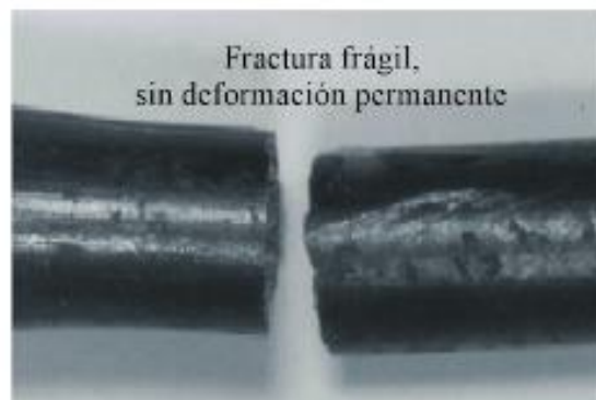
Figura 16. Fractura frágil de un material
