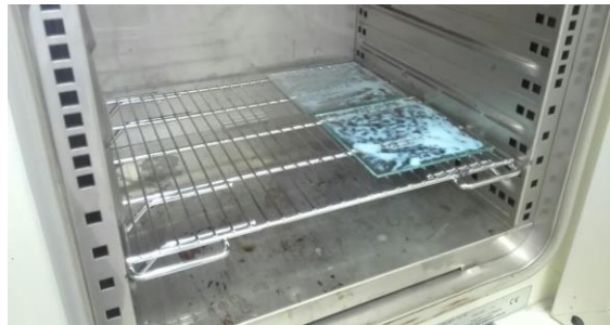
Figura 20. Precalear moldes en horno
