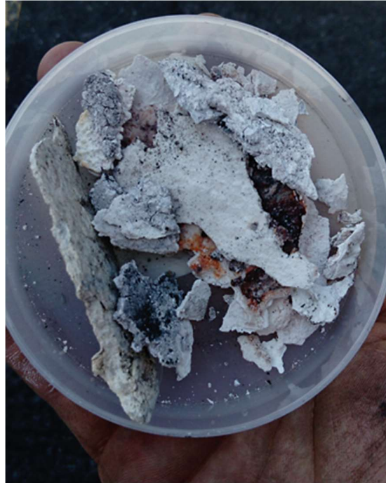
Figura 31. Incrustación removida de los tubos
