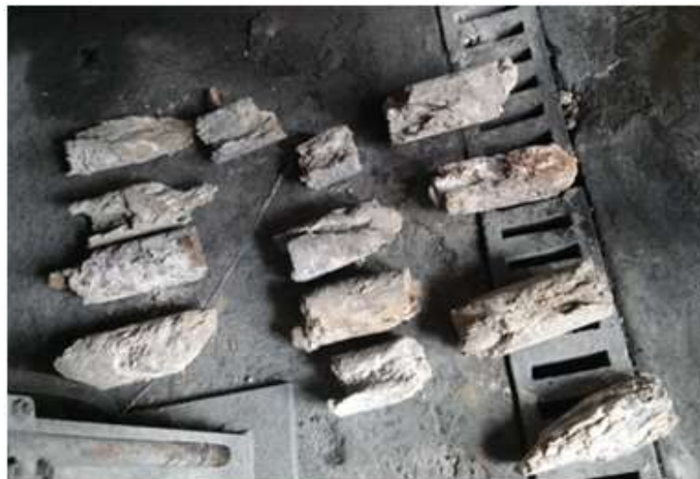
Figura 58. Obstrucciones en tubos de humos, sección pirotubular
