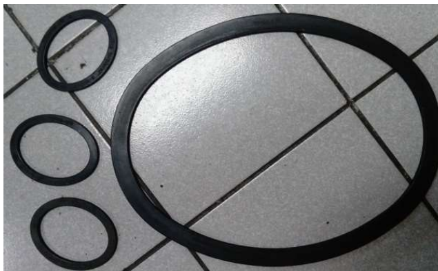
Figura 45. Empaquetadura de registros de caldera
