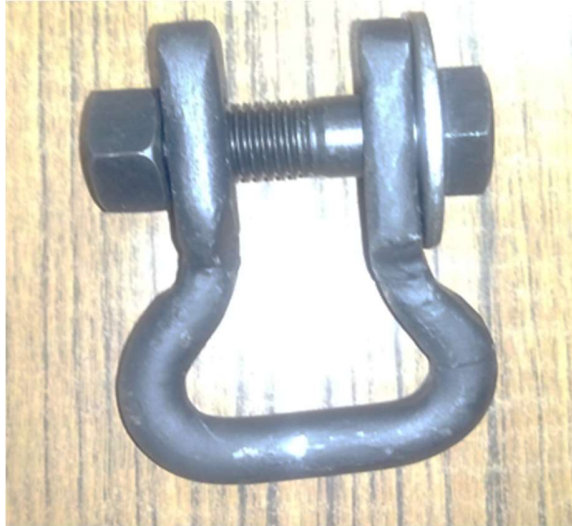
Figura 66. Eslabón de unión nuevo cadena extractora
