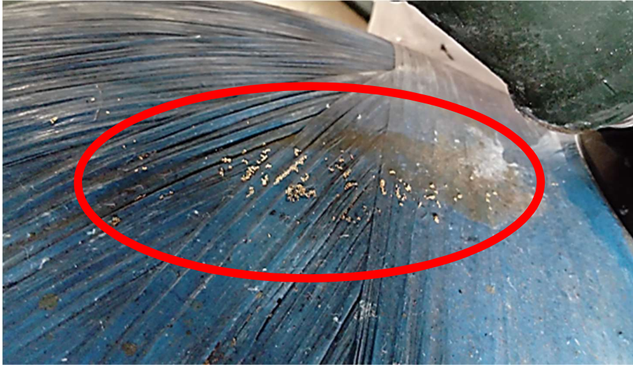
Figura 77. Fuga de resina del suavizador
