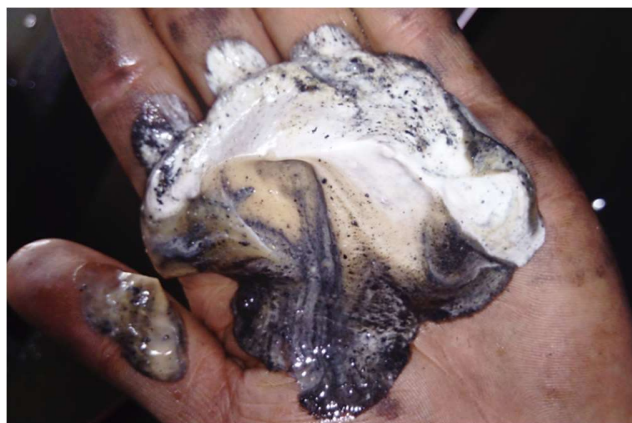
Figura 39. Lodo formado por la desincrustación química
