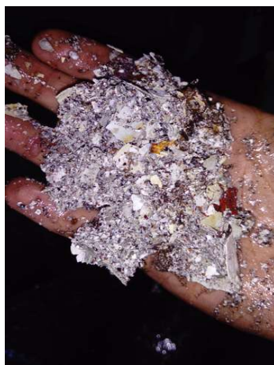
Figura 43. Incrustación tipo escama extraída
