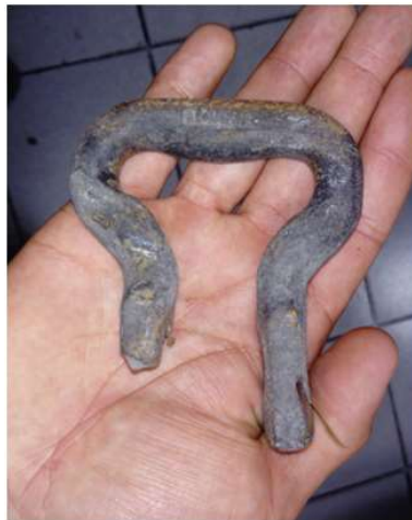
Figura 65. Eslabones dañados del extractor de ceniza
