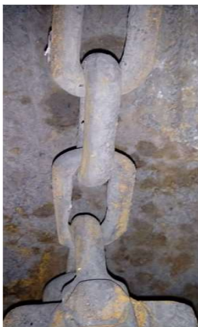
Figura 65. Eslabones dañados del extractor de ceniza
