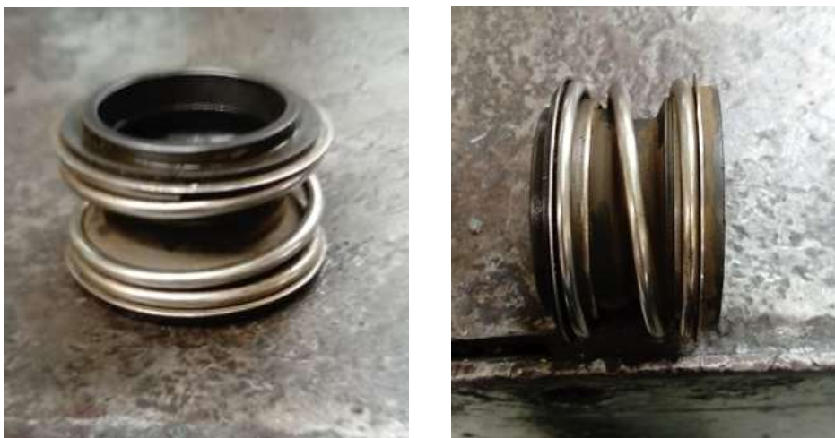
Figura 79. Sello mecánico tipo 21 dañado
