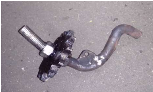
Figura 69. Tensor de cadena dañado
