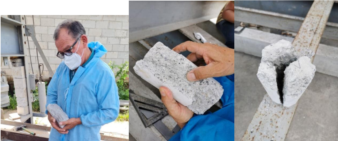
Figura 51. Cilindros de concreto luego de ser ensayados
