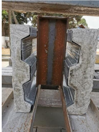
Figura 40. Probeta A de ensayo siendo centrada y nivelada previo a la aplicación de carga
