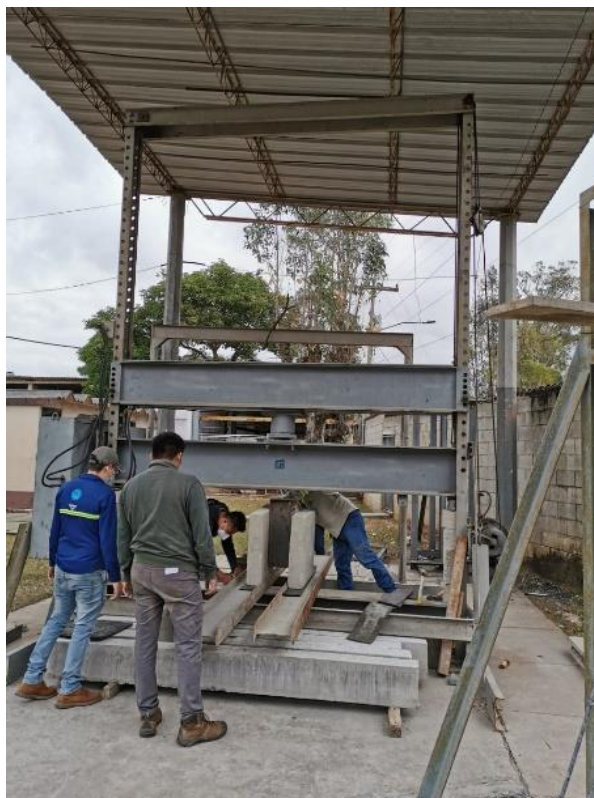
Figura 29. Probeta de ensayo colocada en marco para aplicación de carga
