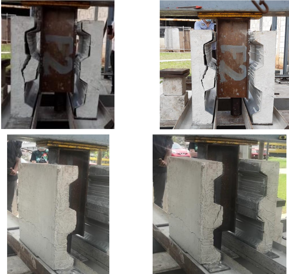
Figura 59. Falla de la Probeta C al alcanzar la carga última
