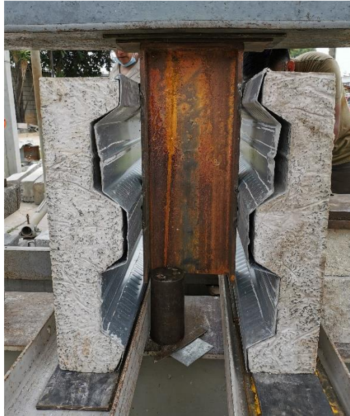
Figura 68. Falla de la Probeta C al alcanzar la carga última
