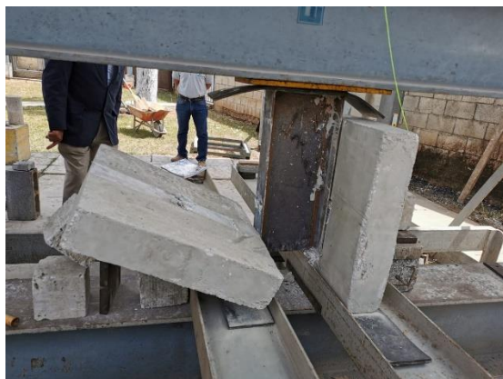
Figura 32. Falla de la probeta de ensayo
