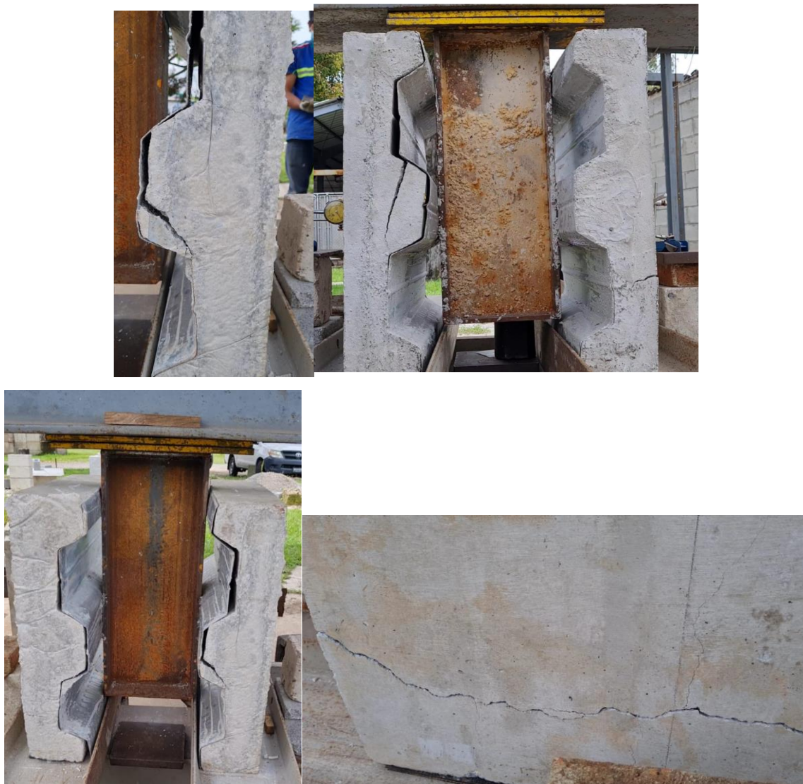
Figura 79. Falla de la probeta C. a) fisuración en la cresta de la losa donde se une con el perno de anclaje. b) falla en la cresta de la losa y fisura a lo ancho de la losa c) separación entre losa de concreto y formaleta metálica d) fisuración a lo ancho de la losa de concreto
