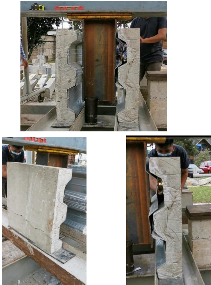
Figura 57. Falla de la Probeta A al alcanzar la carga última
