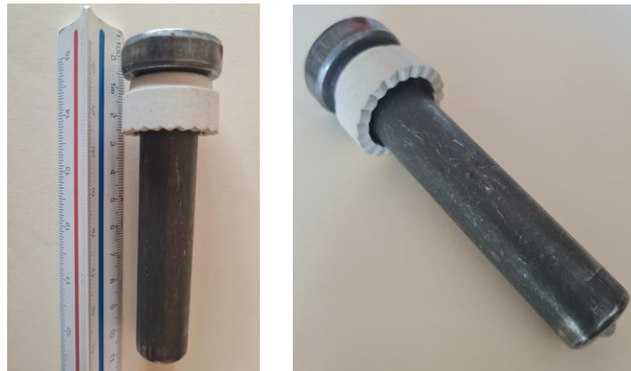
Figura 26. Dimensiones del perno Nelson Stud de \phi=3/4" x 4"
