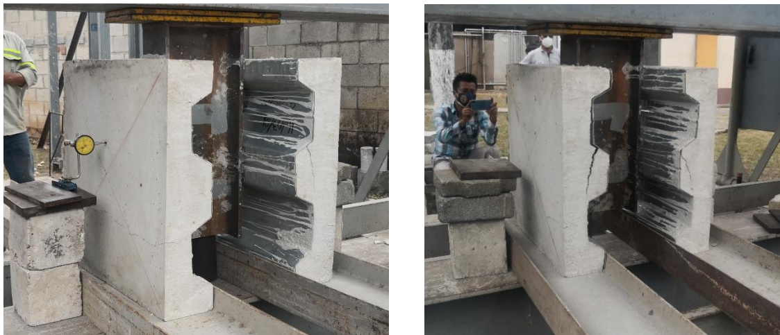
Figura 49. Fallo en losa de concreto de probeta B
