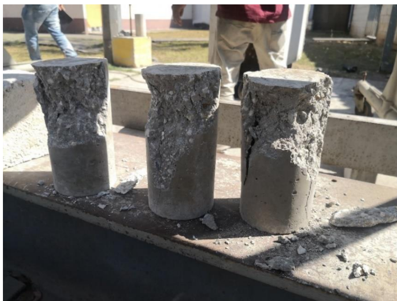
Figura 47. Cilindros de concreto luego de haber sido ensayados
