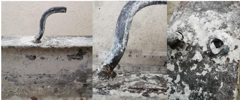
Figura 37. a) vista de perfil de perno elongado, b) medición de la elongación del perno deformado, c) falla en la soldadura del perno
