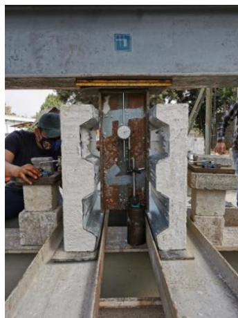
Figura 41. Probeta B de ensayo siendo centrada y nivelada previo a la aplicación de carga
