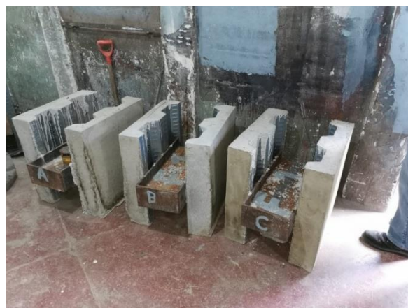
Figura 39. Probetas después de quitar la formaleta para la fundición
