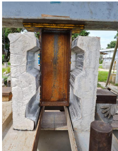
Figura 72. Probeta C de ensayo siendo centrada y nivelada previo a la aplicación de carga
