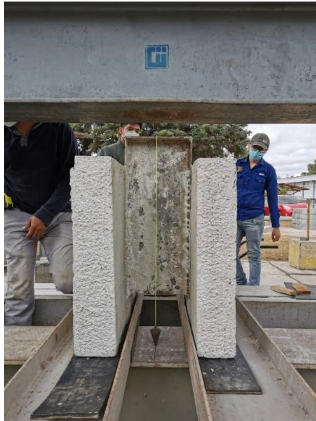
Figura 30. Probeta de ensayo siendo centrada y nivelada previo a la aplicación de la carga
