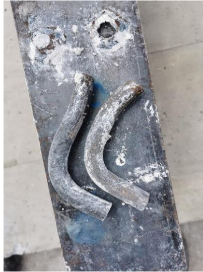
Figura 33. Pernos que fallaron durante la realización del ensayo
