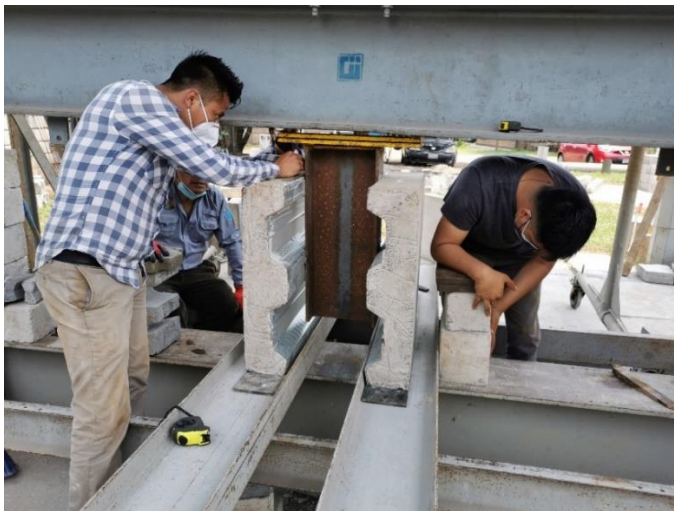
Figura 52. Probeta A de ensayo siendo centrada y nivelada previo a la aplicación de carga
