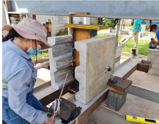
Figura 71. Probeta B de ensayo siendo centrada y nivelada previo a la aplicación de carga
