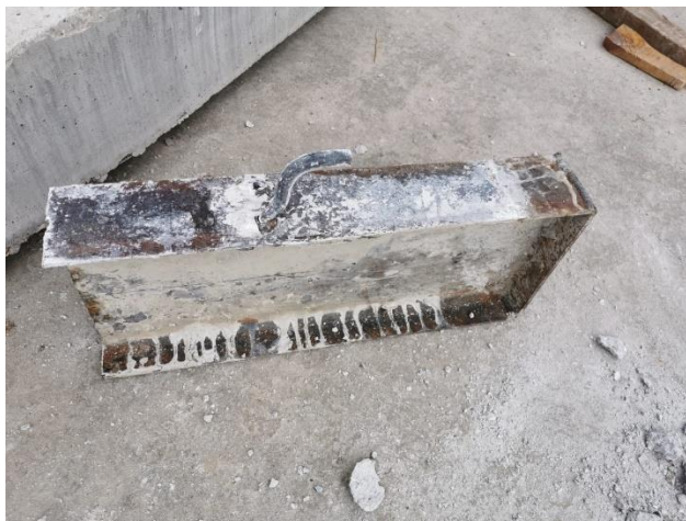
Figura 36. Perno deformado en probeta ensayada
