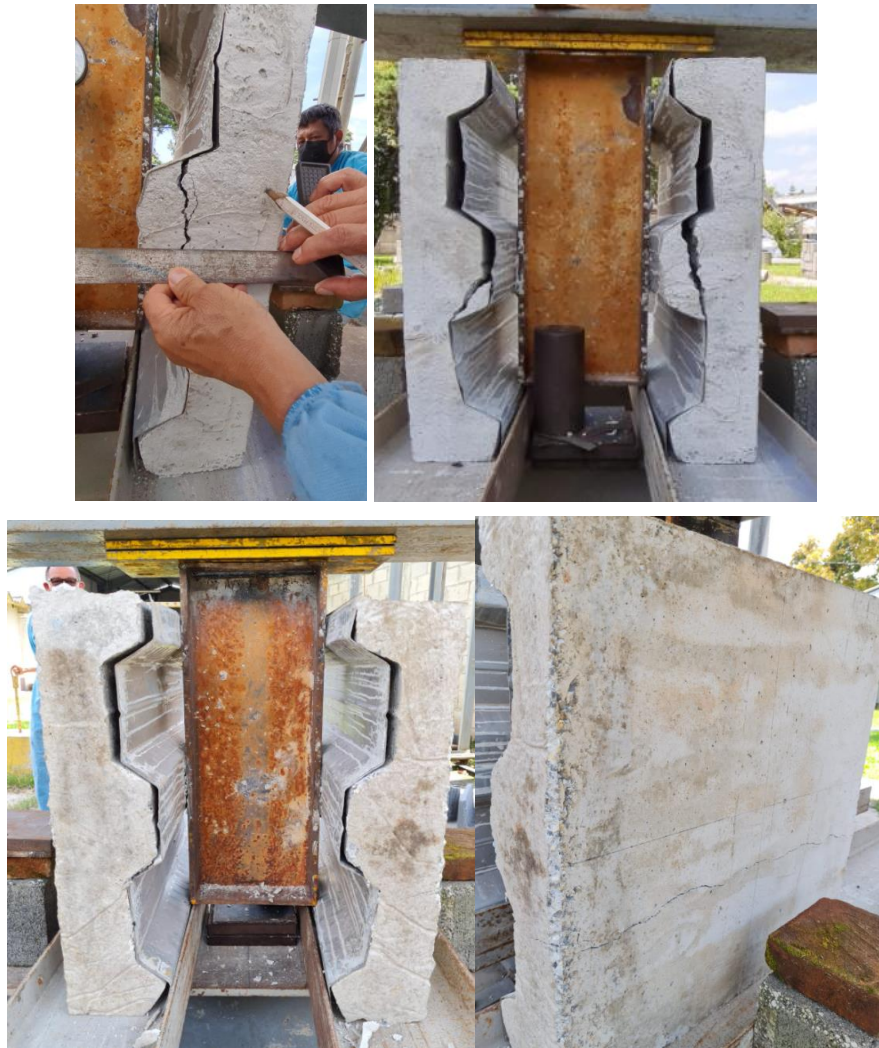
Figura 78. Falla de la probeta B. a y b) fisuración en la cresta de la losa donde se une con el perno de anclaje. c) separación entre la losa de concreto y la formaleta metálica. d) fisuración a lo ancho de la losa de concreto
