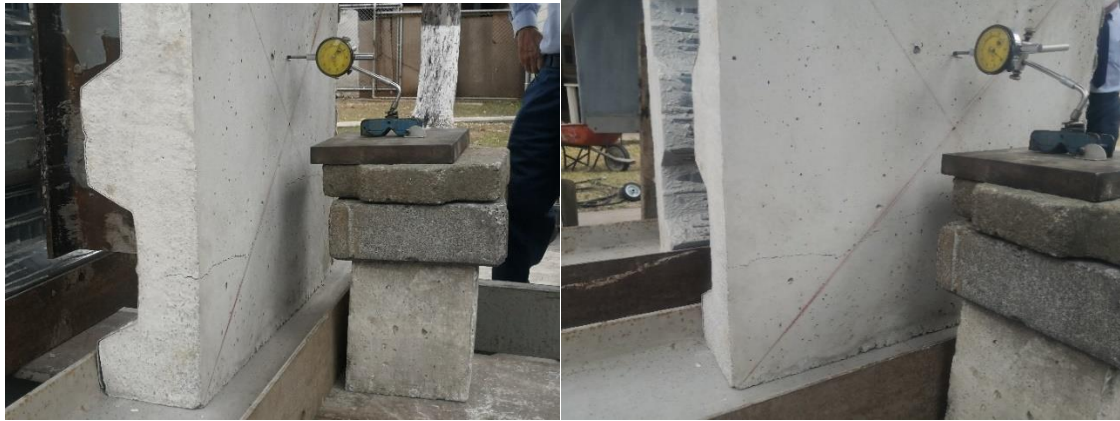
Figura 48. Fallo en losa de concreto de probeta A
