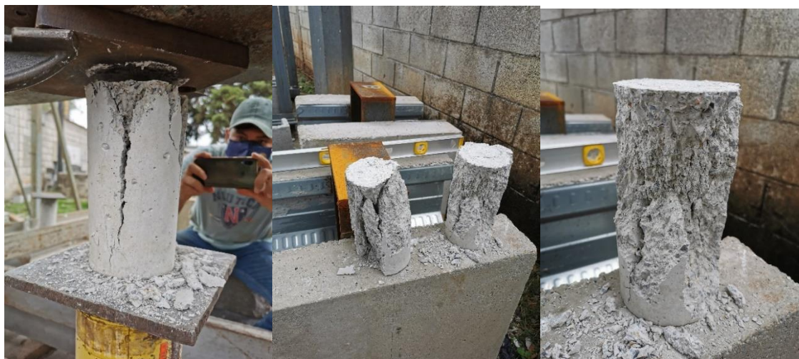
Figura 60. Cilindros de concreto luego de ser ensayados
