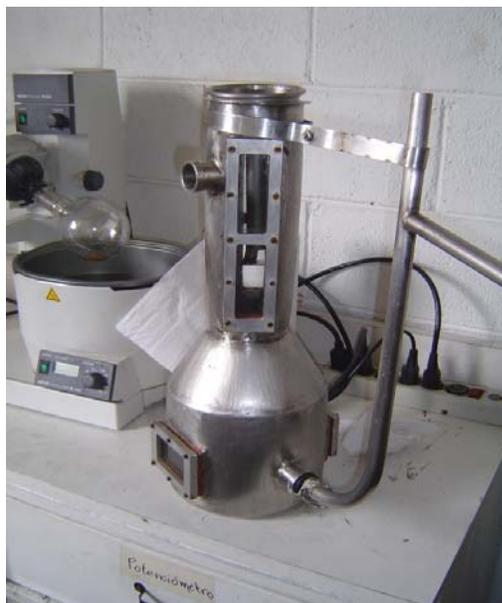
Al concluir con la extracción se descarga de la marmita el lote agotado y se vuelve a cargar para poder realizar otra extracción. El aceite esencial crudo se separa del solvente por medio de un rotavapor, con lo cual el hexano se utiliza en extracciones posteriores.
