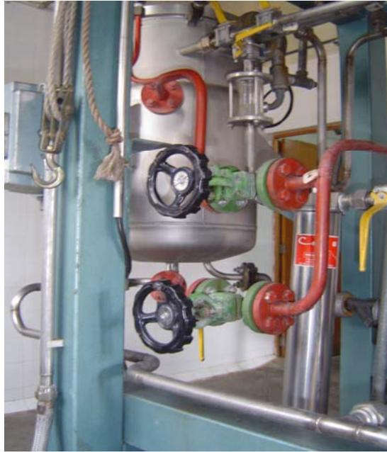
**Figura 14. Equipo de enfriamiento de agua para el intercambiador de calor**
