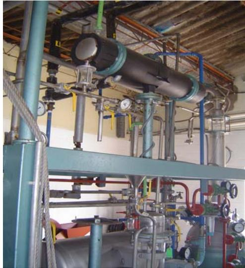
El vaso florentino siempre tiene que estar lleno de agua y si se utiliza solvente para recuperar el aceite, el vaso florentino debe tener una trampa de solvente de unos 300 mL. en cada extracción.
