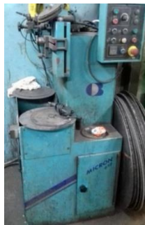
Figura 17. Chaflanadora o biseladora de discos
