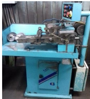
Figura 16. Afiladora de sierras circulares
