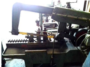
Figura 15. Cortadora de sierra vaivén
