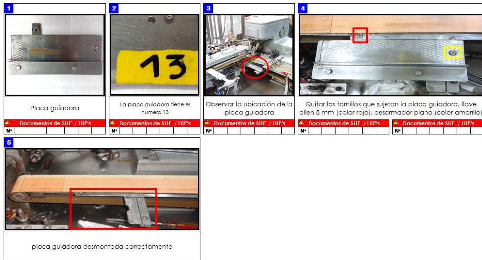
Figura 73. Desmontaje de formato de 8 tabletas, paso 6: placa guiadora
