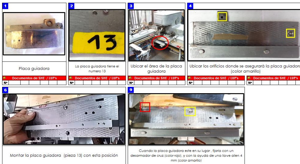
Figura 57. Montaje de formato de 8 tabletas, paso 7: placa guiadora
