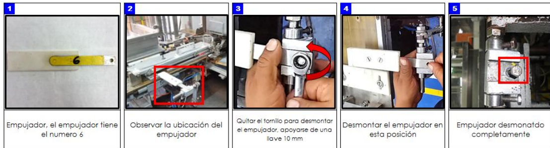
Figura 79. Desmontaje de formato de 8 tabletas, paso 12: empujador
