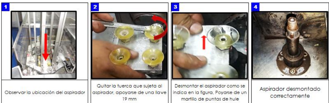
Figura 49. Desmontaje de formato de 24 tabletas, paso 5: aspirador
