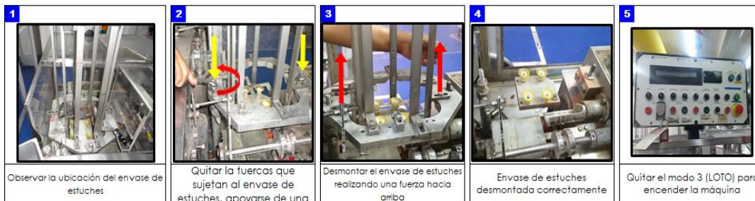
Figura 50. Desmontaje de formato de 24 tabletas, paso 6: envase de estuche
