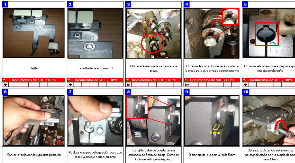
Figura 121. Montaje de formato de 2 tabletas, paso 8: rejilla
