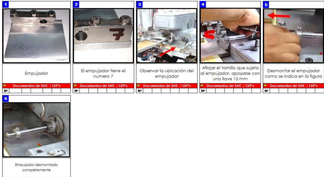
Figura 71. Desmontaje de formato de 8 tabletas, paso 5: empujador
