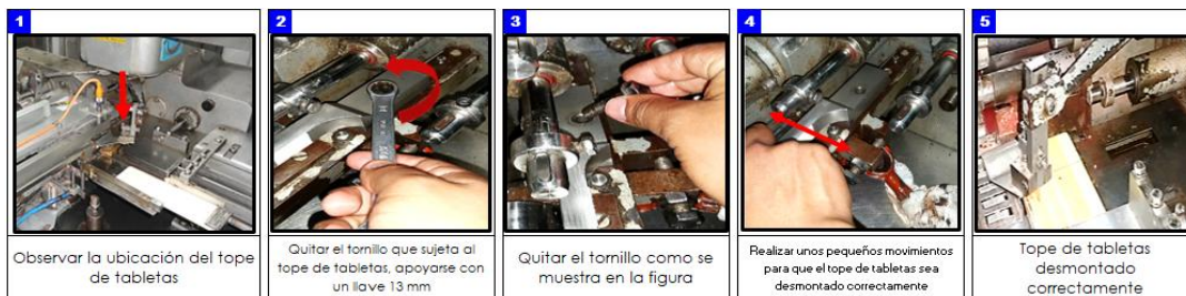
Figura 31. Desmontaje de formato de 12 tabletas, paso 2: tope de tabletas
