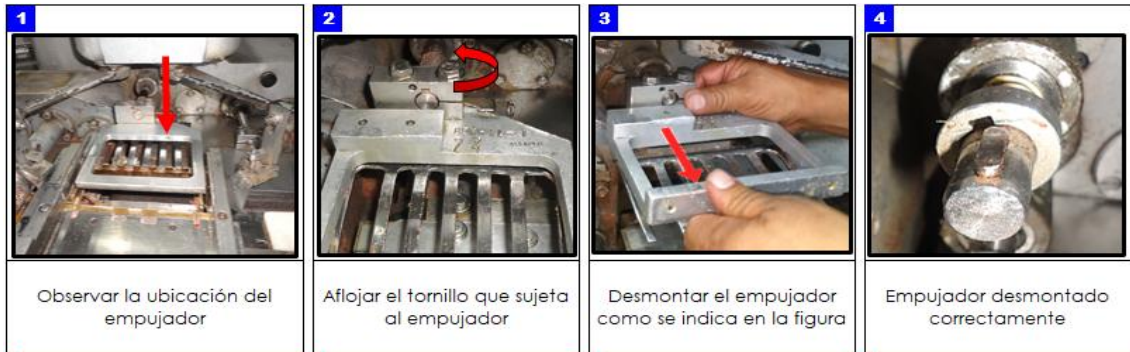
Figura 48. Desmontaje de formato de 24 tabletas, paso 4: empujador
