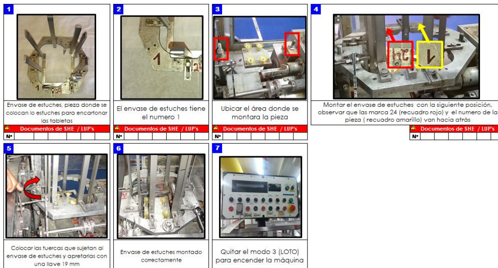
Figura 44. Montaje de formato de 24 tabletas, paso 10: envase de estuche
