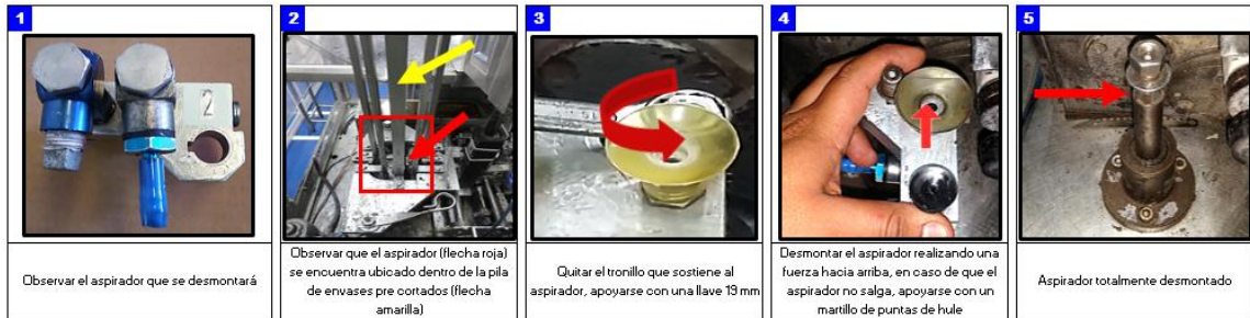
Figura 129. Desmontaje de formato de 2 tabletas, paso 2: aspirador
