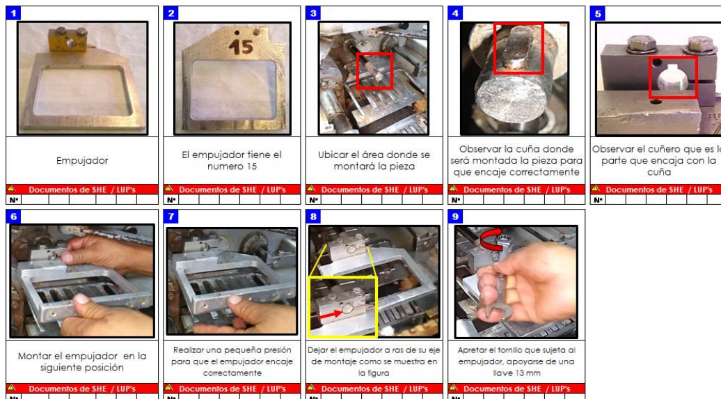
Figura 26. Montaje de formato de 12 tabletas, paso 7: empujador
