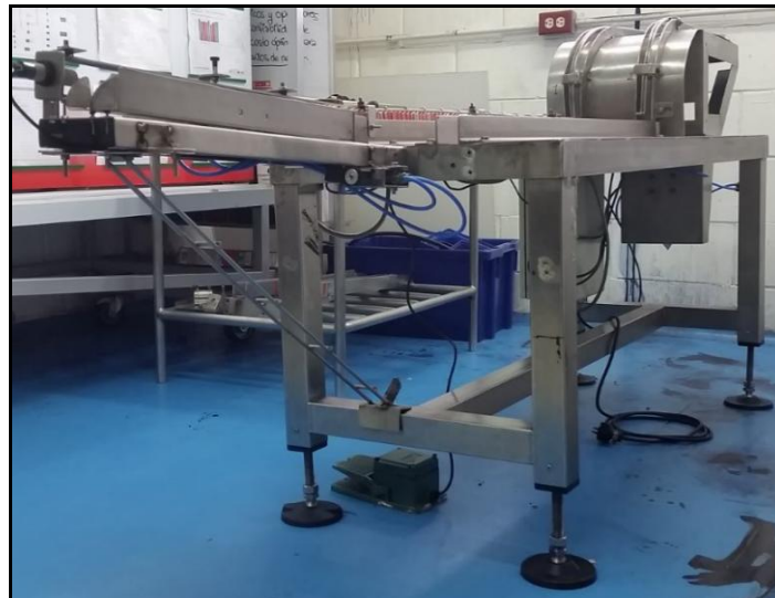
Figura 175. Separador de tabletas montado, se muestra el pedal que desactiva el cilindro
