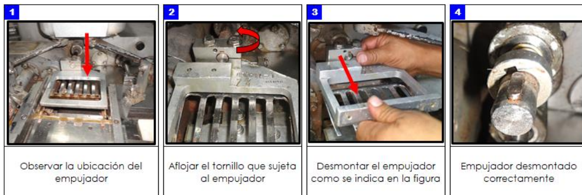
Figura 33. Desmontaje de formato de 12 tabletas, paso 4: empujador
