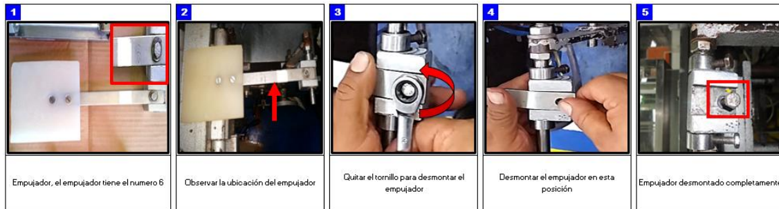
Figura 139. Desmontaje de formato de 2 tabletas, paso 12: empujador
