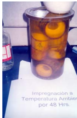
Figura 7. Tratamiento por inmersión simple durante 48 hrs.
