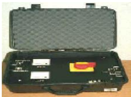
Figura 48. Sistema de control de soldadura Piranha
