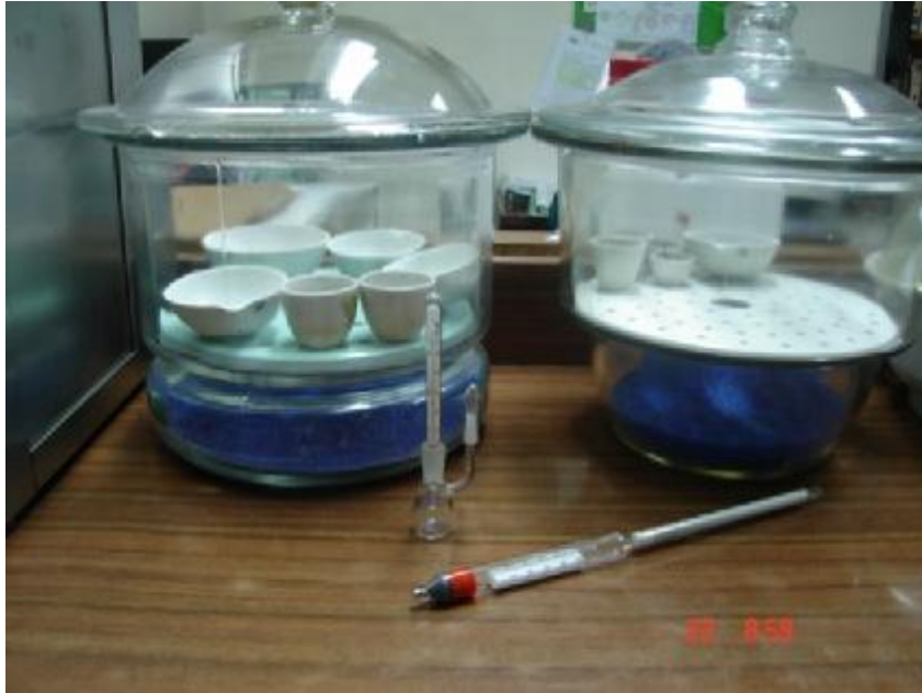
Campanas, alcoholímetro y picnómetro.
