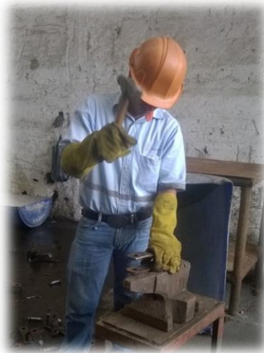
Figura 24. Colaborador alineando eslabones a golpes con martillo
