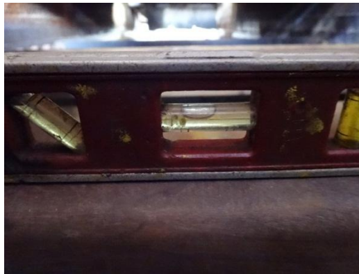
Figura 41. Demostración con nivel en conductor de bagazo #2
