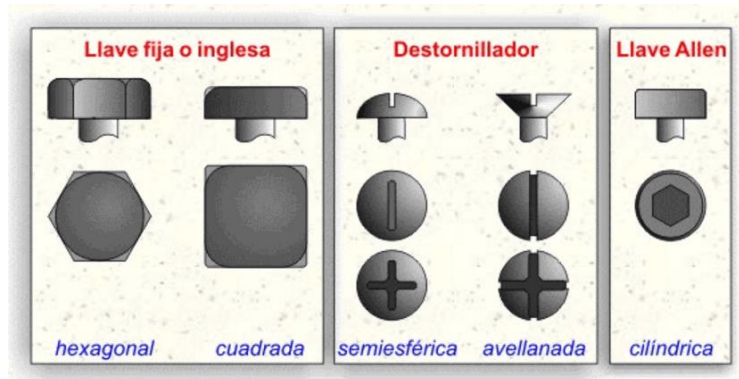
Figura 12. Tipos de cabeza de tornillos
