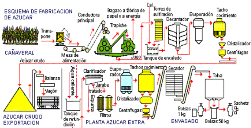
Figura 3. Esquema de fabricación de azúcar
