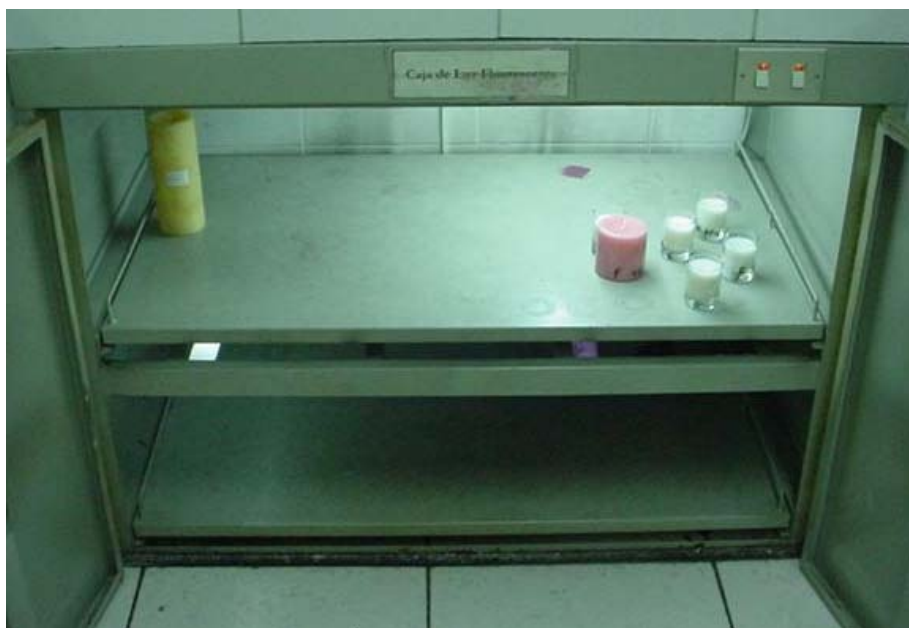
Figura 81. Cámara de luz ultravioleta vista interior
