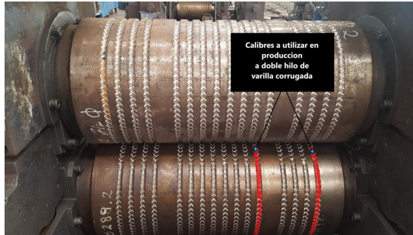
Figura 39. Cilindros para varilla corrugada
