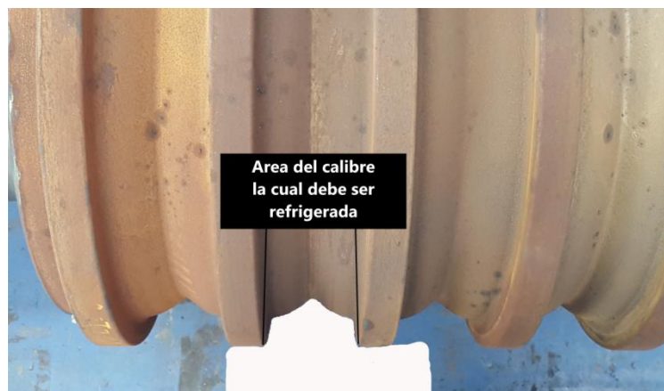
Figura 40. Cilindro para tren intermedio (angular 3")
