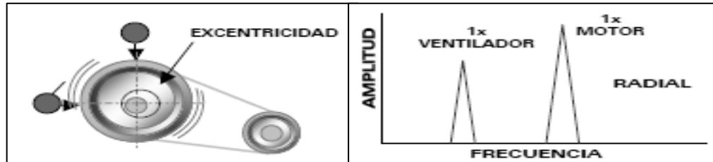
Figura 12. Espectro de excentricidad
