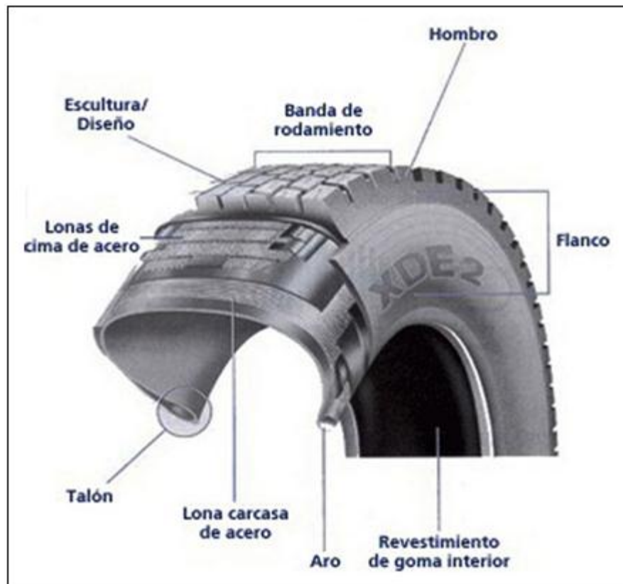
Figura 12. Composición de llanta radial
