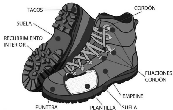
Figura 41. Partes de un zapato de seguridad
