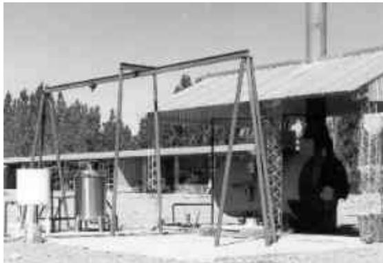
El primero, la retorta o alambique, es donde se deposita el material a destilar. Consiste en un tanque cilíndrico de un diámetro igual o algo inferior a la altura, que tiene en la parte superior una tapa que debe poder ser asegurada y su cierre hermético.
