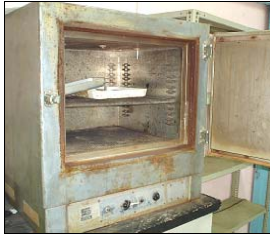
Figura 3. Equipo 3. Horno eléctrico con recirculación
