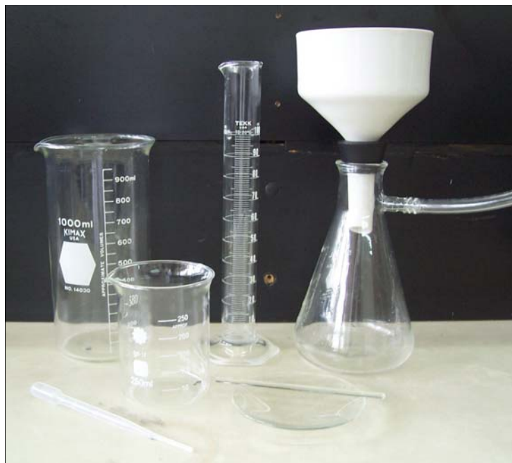
Figura 5. Cristalería. Beakers, vidrio reloj, varilla de agitación, probeta, kitazato, manguera, embudo büchner y pipeta de transferencia.
