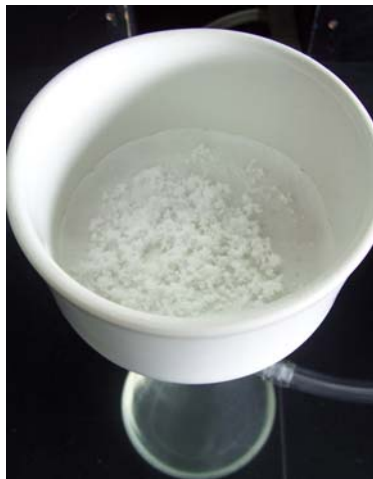
Figura 21. Recuperación de Lactosa en muestra por medio de filtrado
