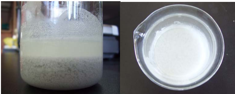
Figura 17. Primer filtrado evaporado, luego de haber agregado alcohol al 95% y carbón activado
