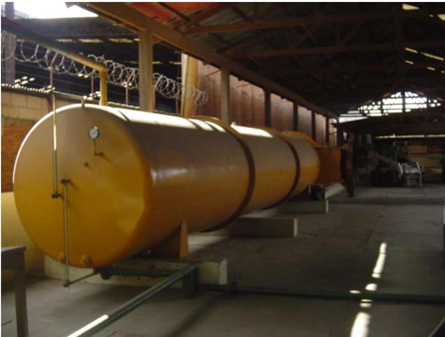
Figura 12. Vista exterior de la impregnadora al vacío.
