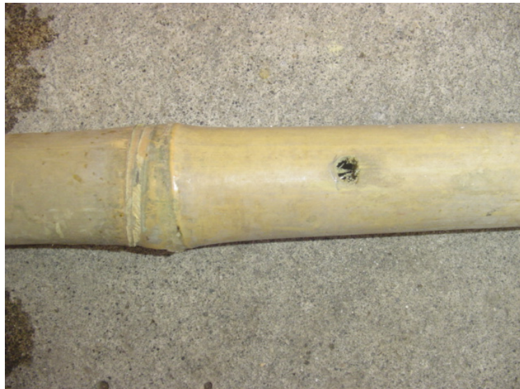
Figura 14. Vista de vara perforada lateralmente en entrenudos.
