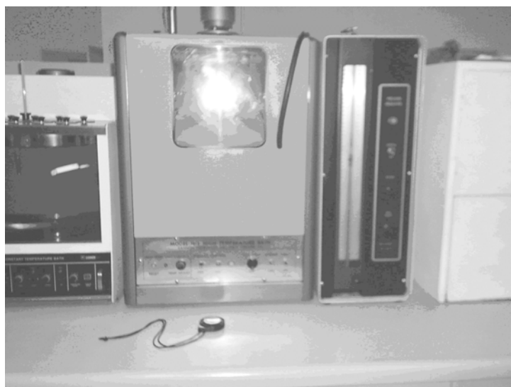
Figura 7. Baño y sistema de vacío
