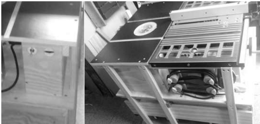
Figura 58. Disposición de los cordones eléctricos
