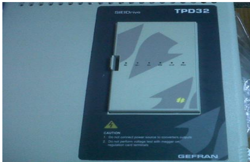
Figura 15. Variador de DC
