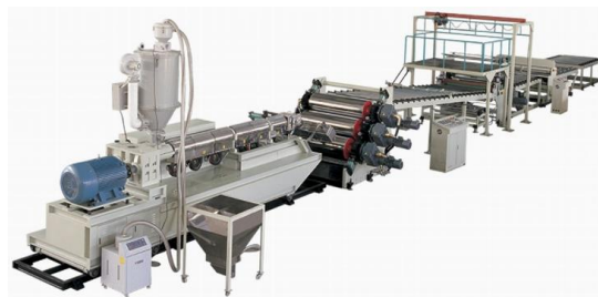
Figura 9. Extrusor con un proceso continuo
