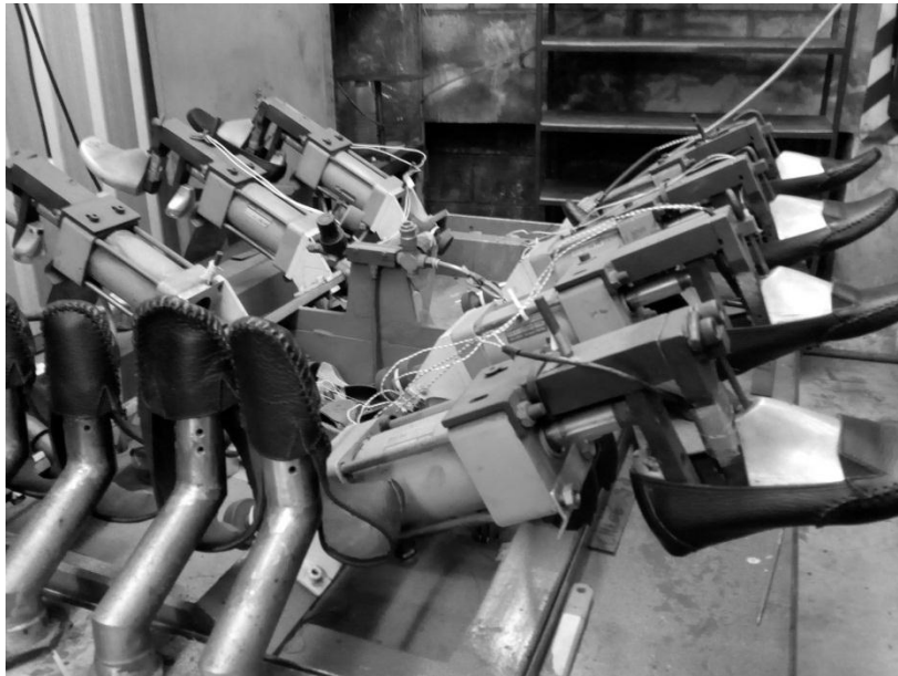
Figura 26. Preconformadora de corte
