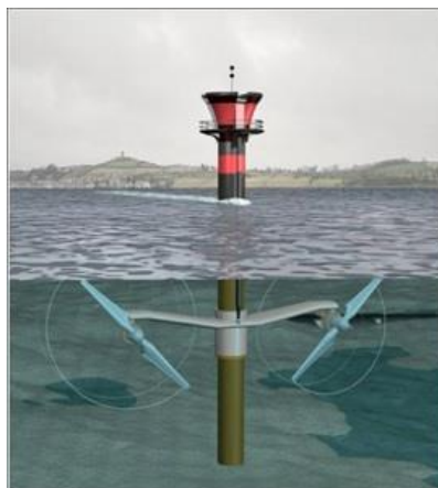
Figura 5. Generador corriente de marea
