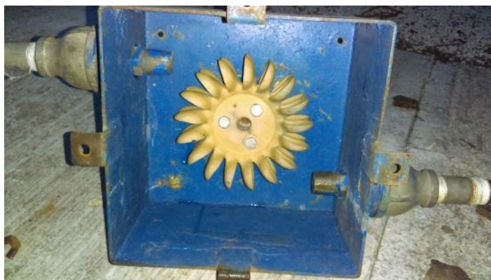
Figura 28. Turbina y toberas
