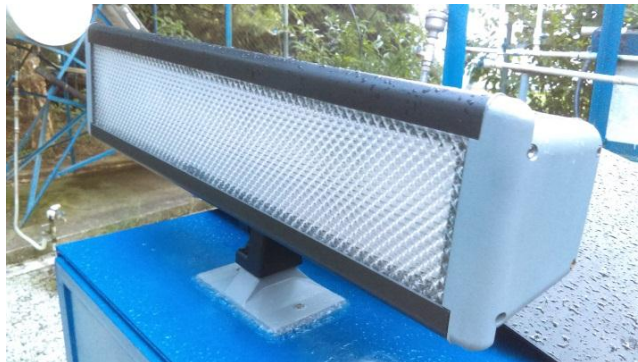
Figura 31. Lámpara led y difusor de luz
