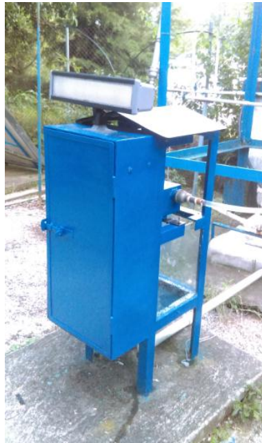
Figura 33. Turbina Pelton finalizada
