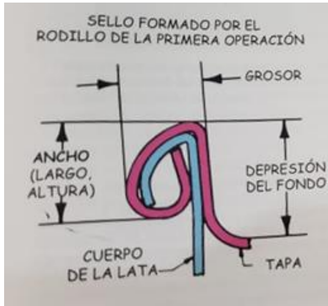
Figura 6. Partes del cierre de un enlatado formado por primera operación
