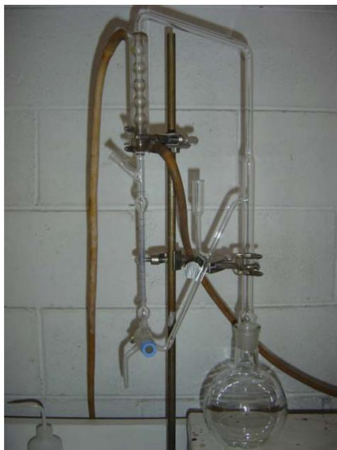
**Figura 4. Equipo para hidrodestilación Neoclavenger en funcionamiento**
