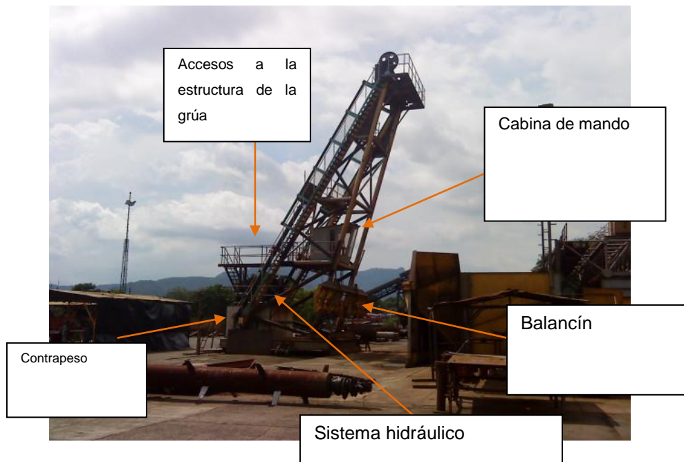
Figura 5. Componentes de una grúa de descarga de caña
