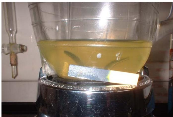
**Figura 22. Cambio de color en la reacción de esterificación a transesterificación.**
