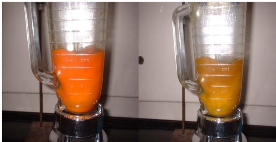
**Figura 19.** Resultado de la esterificación fase pesada (ésteres y aceite sin reaccionar) y fase liviana etanol (clorofila del aceite crudo de palma africana).
