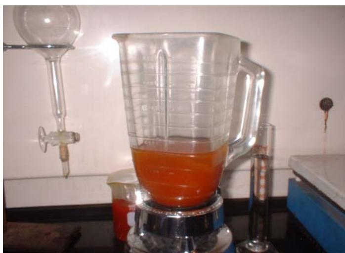
**Figura 23. Mezcla después de una hora sin reaccionar en el proceso de transesterificación.**
