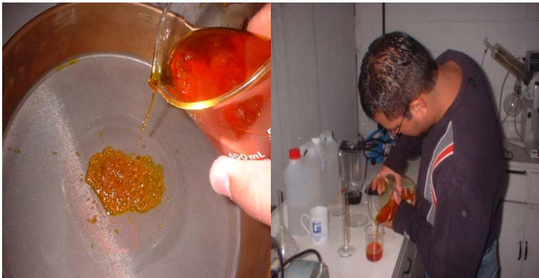
**Figura 25. Biodiésel obtenido por el proceso de esterificación-transesterificación a nivel laboratorio.**
