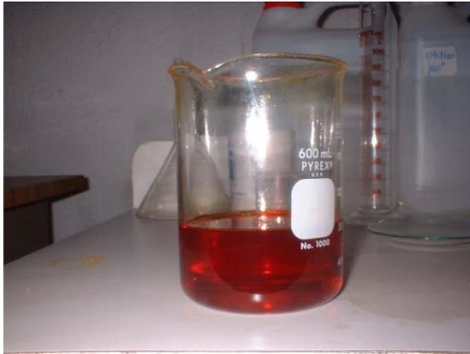
**Figura 26. Biodiésel obtenido por el proceso de transesterificación a nivel laboratorio**
