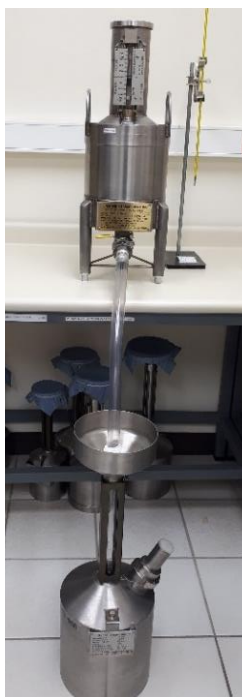
Figura 6. Sistema armado para transferencia de volumen
