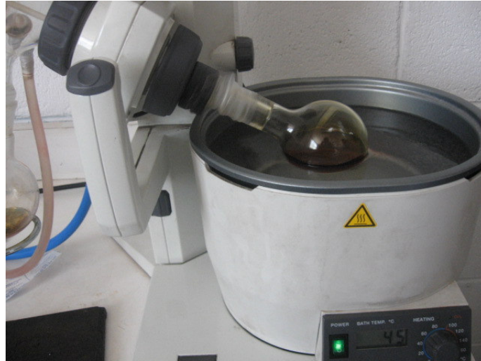
Figura 9. Rotaevaporación de los extractos acuosos y etanólicos
