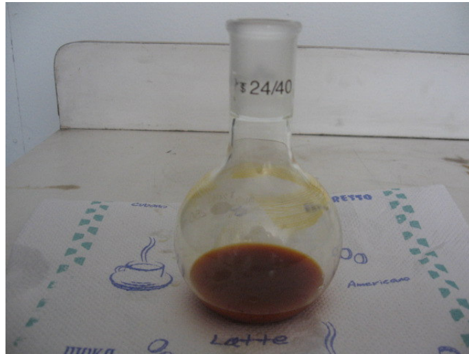
Figura 11. Extracto tintóreo de alnus jorullensis HBK rotaevaporado para tamizaje fitoquímico.
