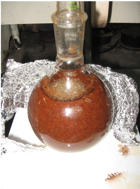
Figura 8. Extracción utilizando el método de maceración dinámica a reflujo.
