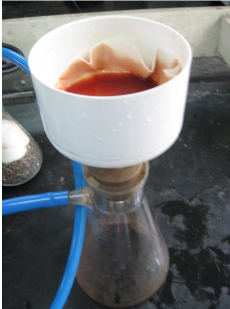
Figura 7. Filtración de los extractos tintóreos.
