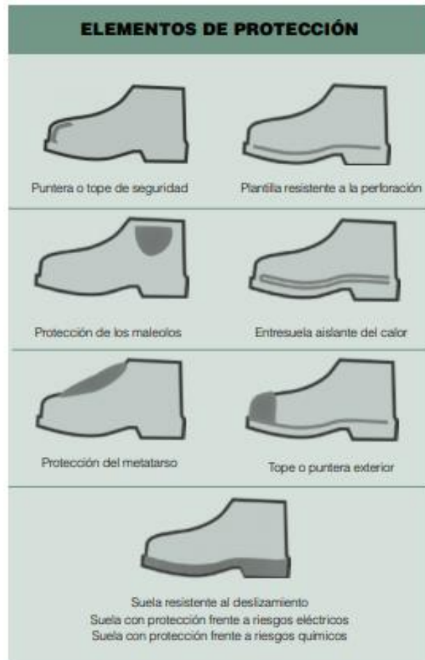
Figura 28. Elementos de protección del calzado industrial
