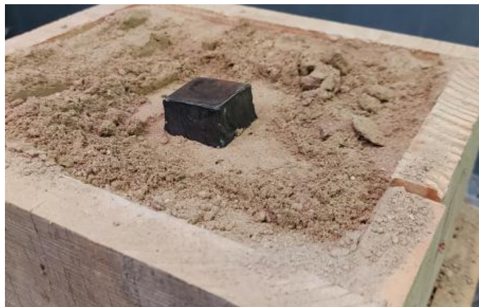
Figura 23. Platina utilizada para transmitir cargas a compresión
