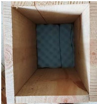
Figura 18. Colocación de esponja en el fondo del molde
