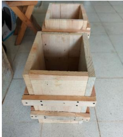
Figura 17. Moldes para colocación de suelo que simula una cimentación.
