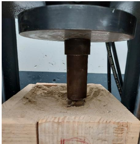
Figura 44. Aplicación de carga a compresión, sobre muestra 2
