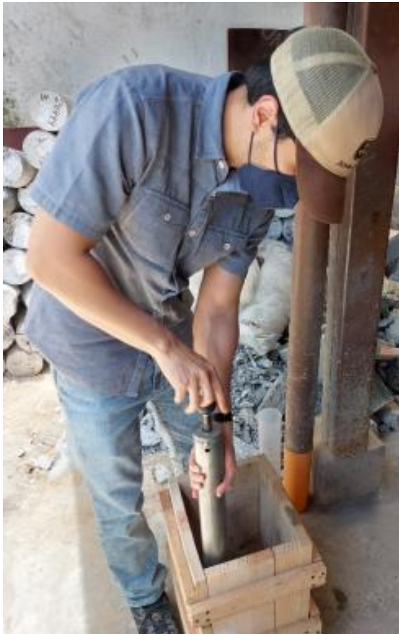
Figura 21. Compactación de muestras de suelo con martillo de Proctor modificado
