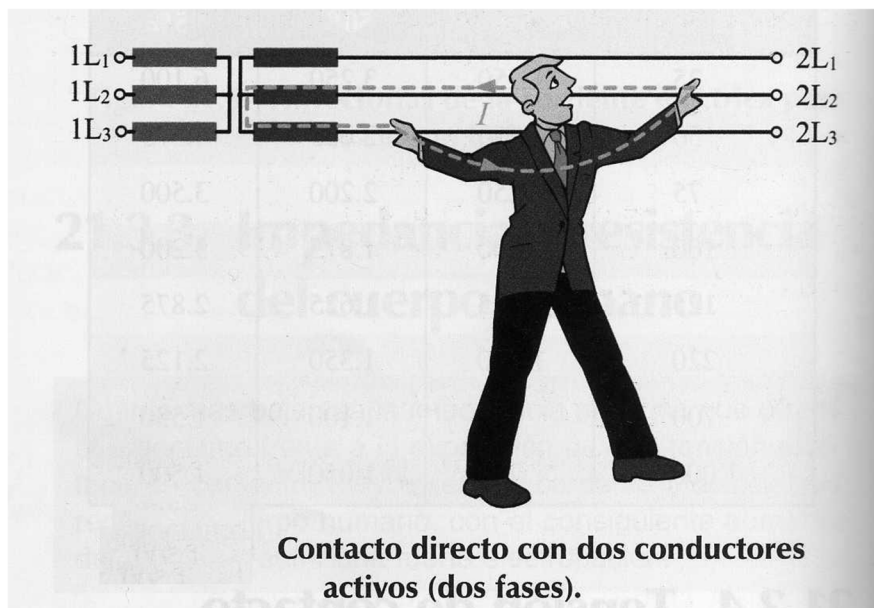
Figura 52. Contacto eléctrico directo
