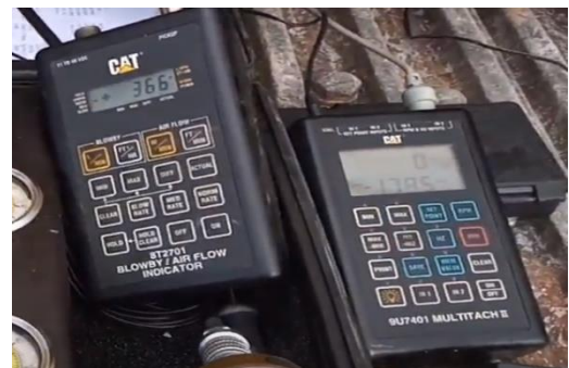
Blowby y RPM con motor en condición de calado.
