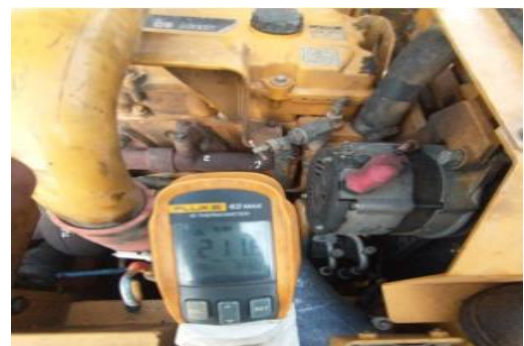
Medición de temperaturas de operación.
