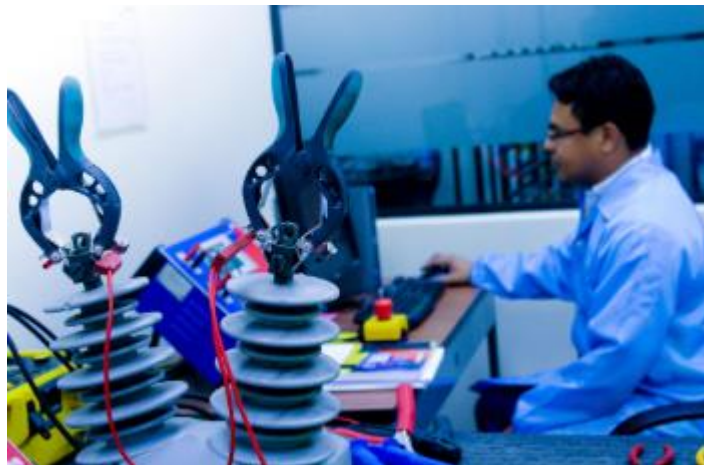
Figura 6. Calibración de transformadores de instrumento
