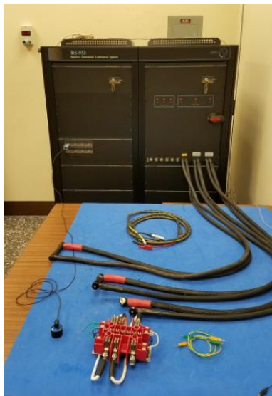
Figura 52. Equipo patrón, cables de conexión, sensor y accesorios
