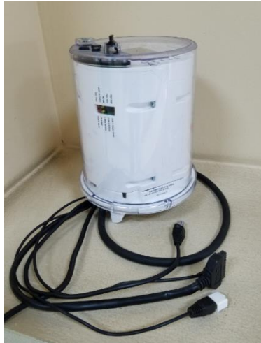
Figura 28. Medidor con tarjeta de comunicación
