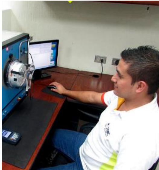
Figura 5. Calibración de un medidor de energía eléctrica
