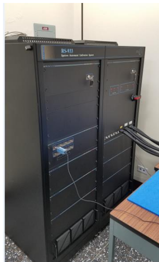
Figura 47. Sistema automático de calibración Radian RS-933
