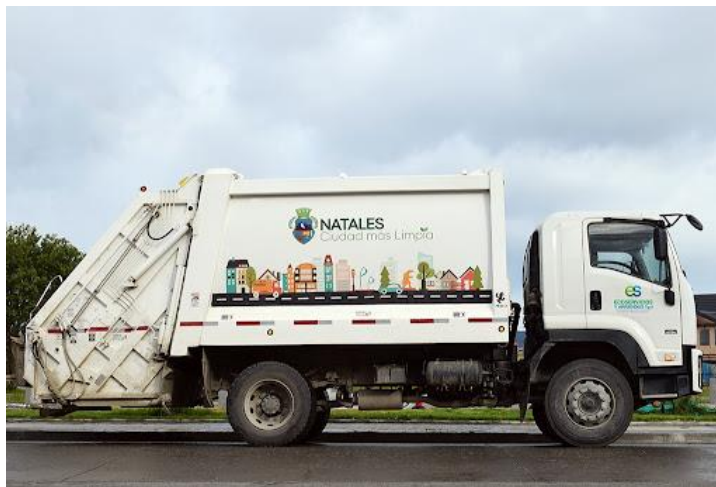
Figura 26. Vehículo recolector de carga posterior como propuesta
