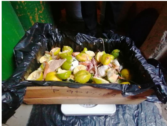
Figura 10. Caja para prueba de densidad
