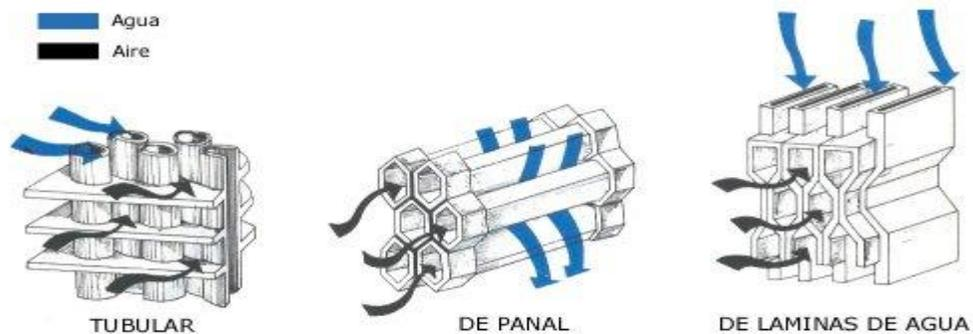
Fuente: Aficionados a la mecánica. *Refrigeración de un motor.*
