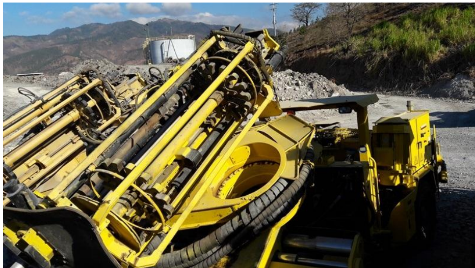
Figura 17. Mesa de avance, brazo manipulador Simba H1354
