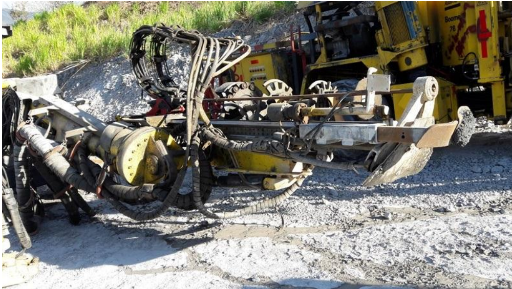
Figura 13. Brazo apernador Boltec
