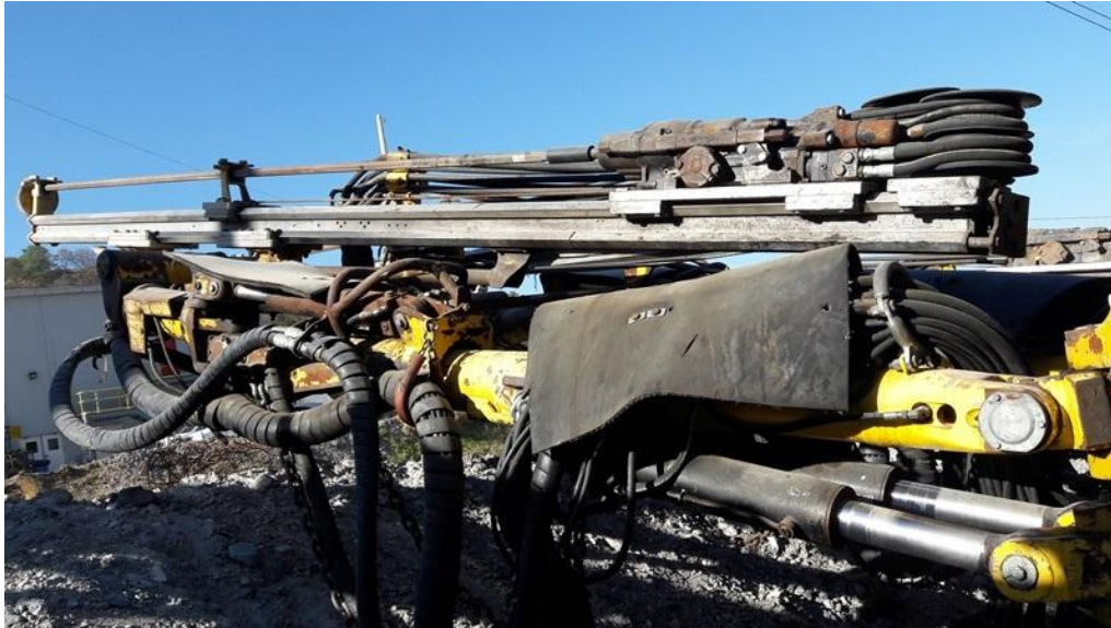
Figura 15. Brazo telescópico Boomer 281/282
