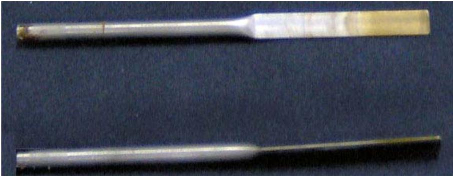
Figura 25. Vistas del calefactor desarmado y armado
