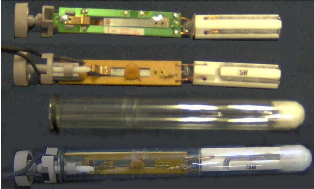
Figura 26. Conductímetro con su respectivo electrodo
