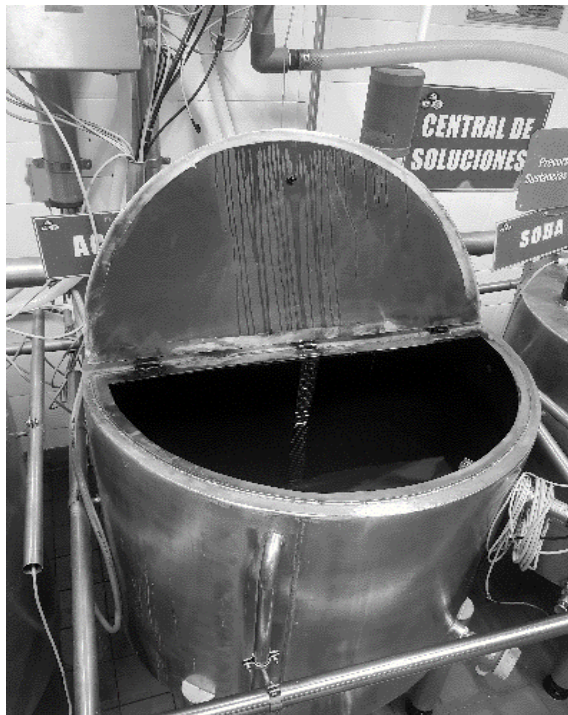
Figura 12. Tanque de solución concentrada
