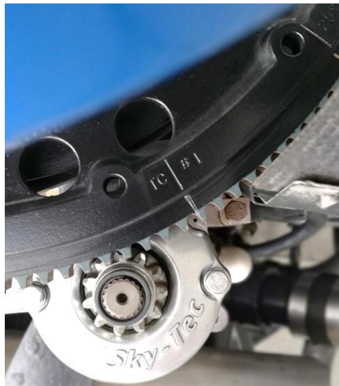
Figura 15. Verificación del Punto TC
