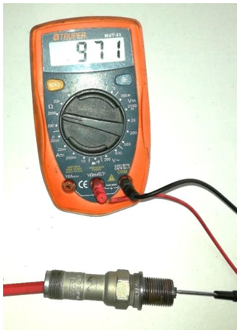
Figura 16. Medición de ohmios de bujías
