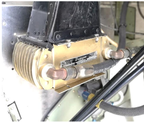
Figura 20. Enfriador de aceite
