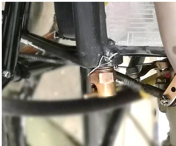
Figura 19. Válvula de drenaje de aceite
