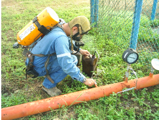
Figura 7. Toma de muestra en cabeza de pozo
