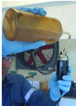
Figura 11. Aplicando solvente a la muestra de petrleo
