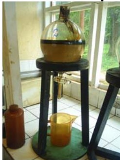
Figura 9. Decantador para muestras de petróleo
