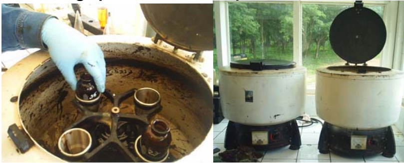
Figura 12. Centrifuga para muestras de petróleo, vista interna y externa
