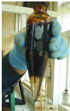
Figura 13. Tubo de centrifuga con muestra de petróleo, al salir de la centrifuga
