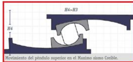
Figura 49. Péndulo superior para máximo sismo creíble
