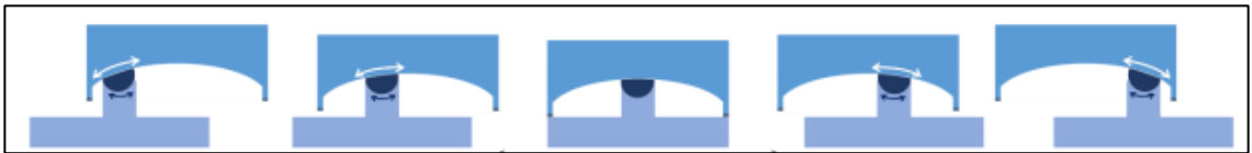
Figura 5. Movimiento característico del sistema de péndulo de fricción
