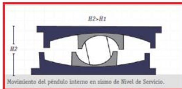
Figura 47. Péndulo interior para sismos frecuentes
