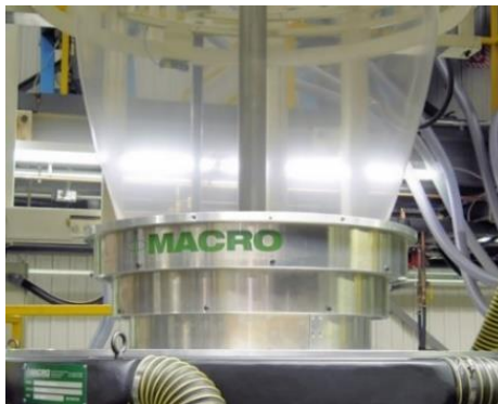
Figura 18. Anillo de enfriamiento
