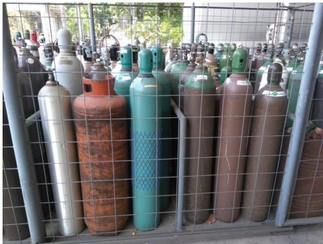
Fuente: Productos del Aire, *Separación de cilindros llenos y vacíos*.
