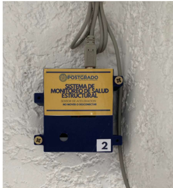
Figura 30. Sensor de aceleración en funcionamiento
