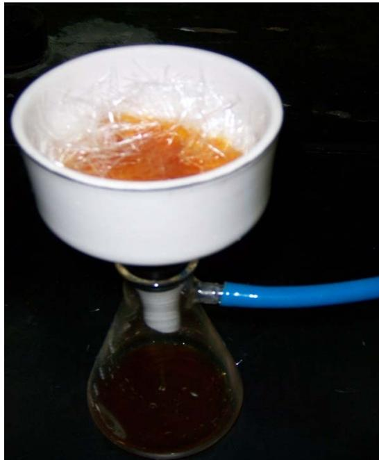
**Figura 28. Filtración al vacío de los extractos de la madera.**
