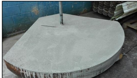
Figura 46. Puerta trasera luego de proceso de fundición de refractario
