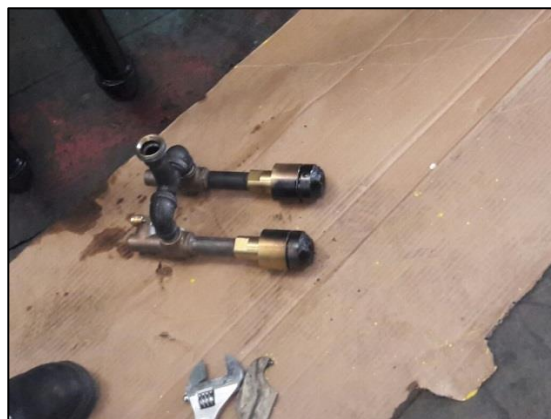
Figura 74. Limpieza de inyectores de bunker
